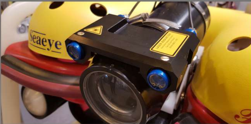
MVL-2 instalado en un vehículo SAAB SEA EYE mod. FALCON
