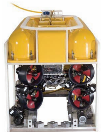
PANTHER-XT PLUS MOSTRANDO EL COMPARTIMENTO PARA LAS BANDEJAS DE HERRAMIENTAS
