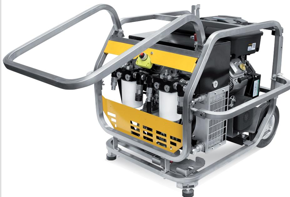
**SUPER RAPTOR DUAL** es un grupo hidráulico con motor de gasolina de 23 CV con arranque eléctrico, desarrollado con doble circuito hidráulico. La máquina dispone de una doble posibilidad de alimentación hidráulica: dos circuitos hidráulicos de 20 L/min cada uno o combinados en un único circuito a 40 L/min con una presión máxima de 170 Bar. La aceleración del motor es manual. La selección del tipo de caudal y aceleración se puede realizar en poco tiempo mediante válvulas solenoides.
