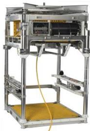
Sistema de gestión de cable umbilical (TMS) tipo 8 que permite el despliegue del vehículo a una profundidad de trabajo mayor proporcionando protección.
