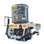
Sistema de gestión de umbilical tipo Top Hat con un módulo de cabrestante de 400 m para un cable de 20 mm equipado con sensores de estado del cierre y de salida de línea. Las opciones incluyen luces y cámaras.
