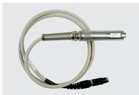
La sonda está diseñada para usarse con un cable de sonda especial envuelto en una trenza exterior de fibra de vidrio para proteger el cable.
